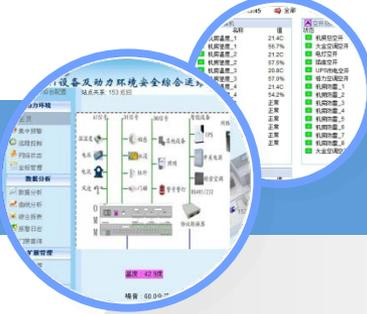
**概述：**表现形式为采用嵌入式采集器（数字、模拟信号的采集等），通过嵌入式采集器与前端监测设备进行连接，实现对机房内所有其它设备的集成监控。
