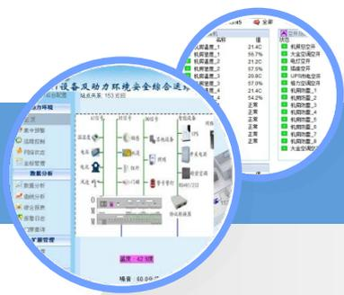
**概述：**这一模式的产品大多是通过工控机和工业组态软件为表现形式，通过工控机上面安装多串口卡连接转换模块从而达到与智能设备的通讯。
