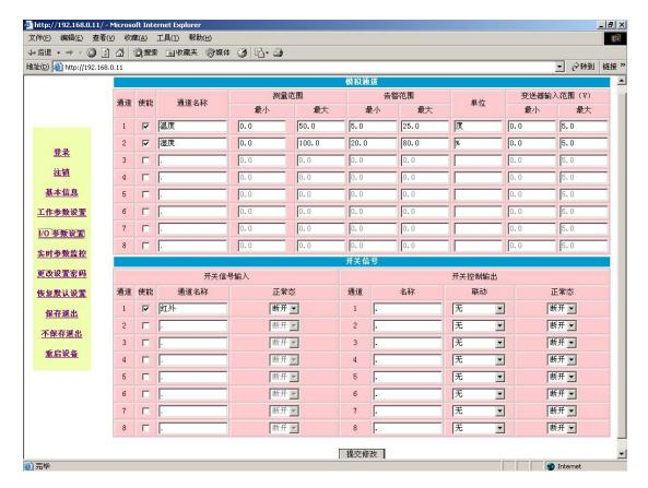
此 WEB 页面为设置模拟量/开关量输入,开关量输出通道的相关名称、测量范围、报警范围(阈值)、正常状态、单位、变送器输入范围以及联动的通道指向等。完成后点击"提交修改"
