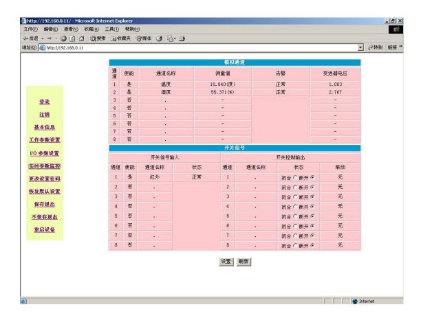
通过上一步的通道参数设置,在此页面将看到当前所接各类变送器的实时采集数据、状态是否正常以及联动状态,手动控制的 DO 通道可手工选择状态的闭合还是断开,而达到控制的目的。建议通过上层网管平台软件进行操作。
