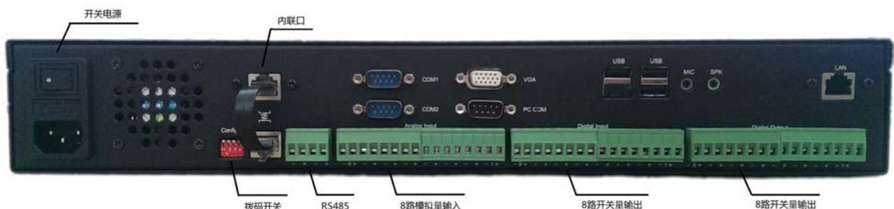
“网安”系列 MACROX 万联碉堡监控机整机包括 6 种接口：数据传输通信网络接口、遥测接口、遥信接口、遥控接口、标准协议串口、外设（键盘、鼠标、显示器、带内串口通信设备）接口等。
