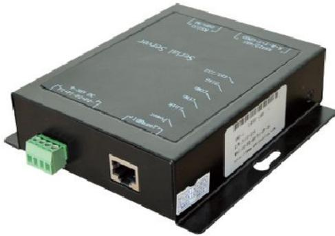
SNS-3-THR 是专门为数据中心机房设计的高可靠性多点温湿度采集网关服务器，采用 32 位 CPU，8M Byte RAM，16M Byte Flash，支持双电源输入，9~36V 直流输入。利用 SNS-3-THR 可以将数据中心机房环境或机柜微环境的温湿度采集数据通过以太网上传至监控中心。使用 SNS-3-THR 温湿度网关可以方便的将现场繁多的温湿度传感器升级为带以太网口的网络设备，取代前置监控 PC 机，降低成本。加上 SNS-3-THR 温湿度网关的硬件和软件双看门狗设计，避免了因设备联网服务器宕机带来的损失，极大的减少后期维护的投入。
