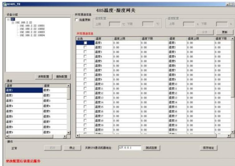
3-3、选择“批量更新”，根据自己的需求填写温度配置和湿度配置的上下限，然后选择要修改的通道
